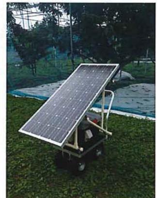
独立電源システム
