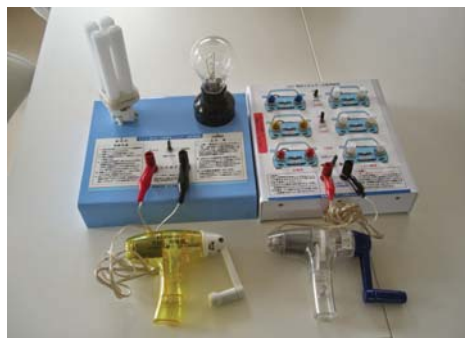
エコ学習トランク (手回し発電機)
